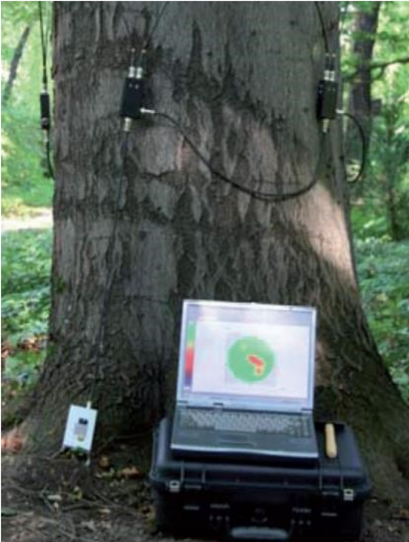
Fig. S4 - Esempio di rilievo tomografico sonico.
